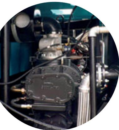
Винтовой блок увеличенного размера соединён с дизельным двигателем напрямую через эластичную муфту. Скорость блока соответствует скорости двигателя, что обеспечивает более длительный срок службы компрессора. Двигатель бренда «Cummins» имеет низкий расход масла. Система послепродажного обслуживания этой компании охватывает всю Россию, благодаря чему клиенты обслуживаются быстро и качественно
